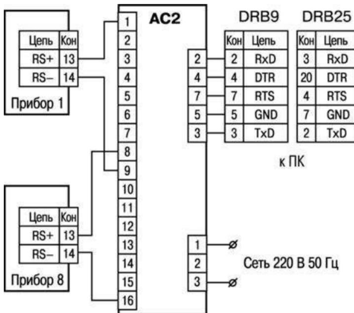
Рисунок Б.2 – Подключение приборов МПР51-Щ4
