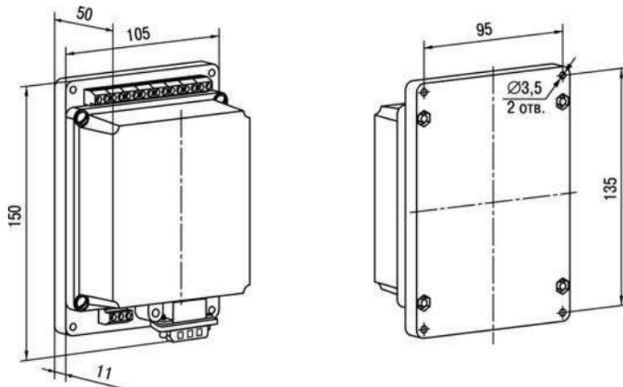
Рисунок А.1 - Габаритный чертеж адаптера AC2
